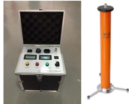
HV DC Generator
